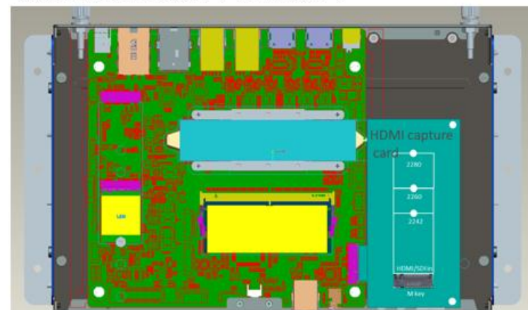
模組化設計：主機板 + HDMI擷取卡
